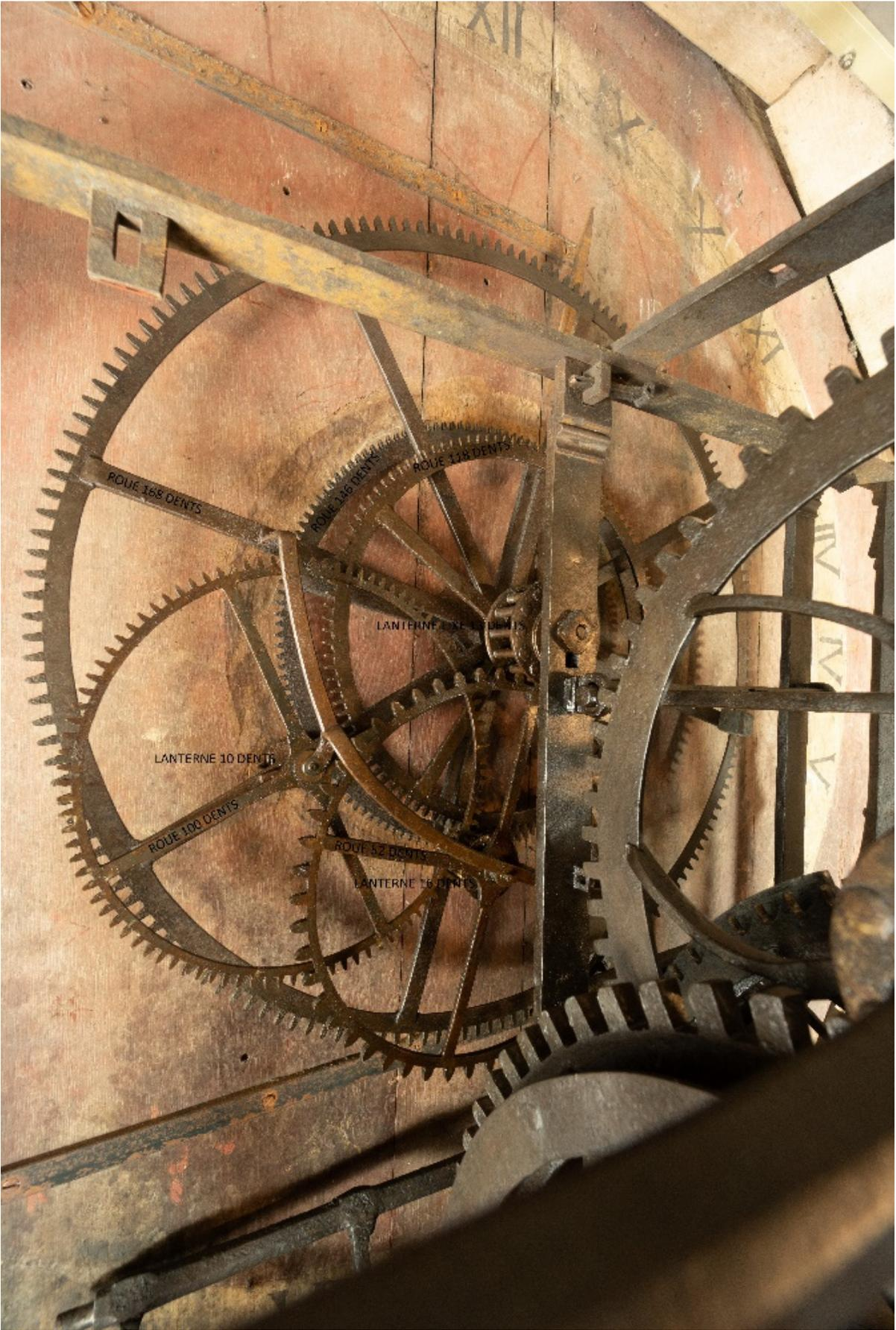
Ce mécanisme est en mis en fonction par la roue du compte temps qui fait 1 tours par heure.
