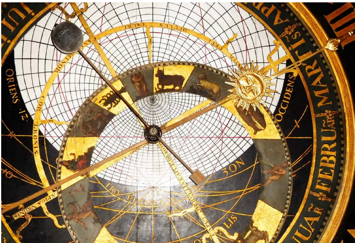
La lune et le soleil, les constellations, la partie visible du ciel avec le pôle nord, le zénith de Saint-Omer, les azimuts et cercles de hauteurs, les trois horizons, les maisons astrologiques.
